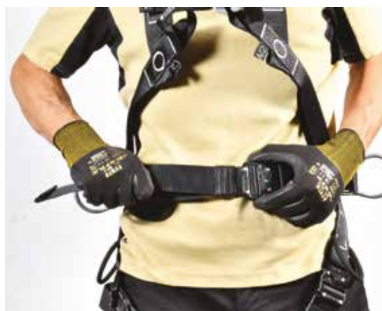
5) Anhängen, schließen und einstellen: hängen Sie den Gurt ein, verschließen Sie ihn und stellen Sie den Gurt auf den Körper ein.
