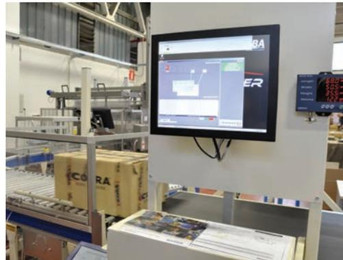
Jeder Umkarton wird vermessen und gewogen. Sollte das Gewicht nicht stimmen, wird der Umkarton aufgrund einer in unserem EDV-System eingegebenen Toleranz abgelehnt und der Inhalt muss von den Mitarbeitern wieder geprüft werden.
